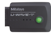
U-WAVE-T※（連接量測儀器） No.02AZD880G ※ 需要另外準備連接線（選購品）。 No.02AZD790D
