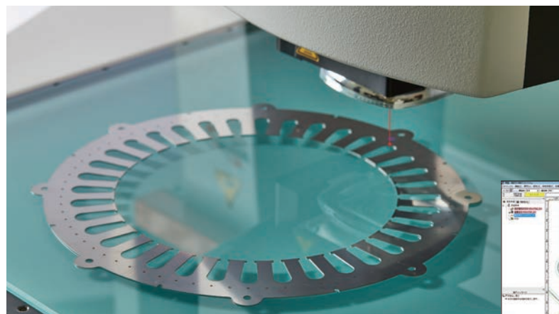
EV用馬達鐵芯的輪廓形狀量測
