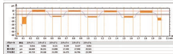
透過PFF量測SMD端子高度的範例
